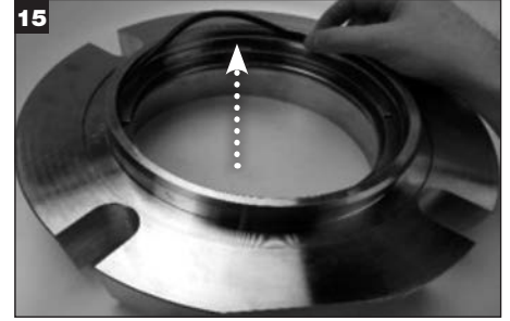
15 Poista O-rengas (X) laipan sisäpinnalta ja hävitä se.
