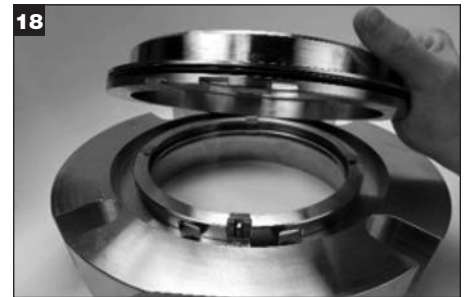
18 Poista sovitin laipasta. Poista sovittimen O-rengas (Z) ja hävitä se. Aseta sovitin sivuun.
